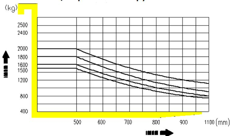
\*При наличии функции бокового смещения вил, грузоподъемность уменьшается на 150кг.
