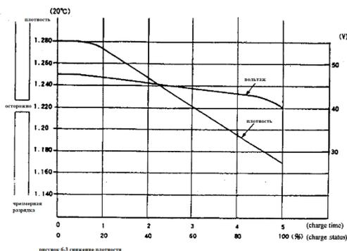
рисунок 6-3 зависимость плотности
