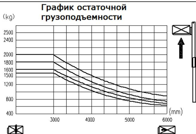
\*При наличии функции бокового смещения вила, грузоподъемность уменьшается на 150кг.
