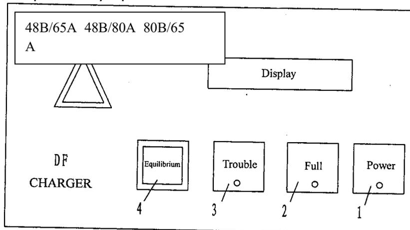
1. При подключении к сети и включении выключателя загорается индикатор "Power".
